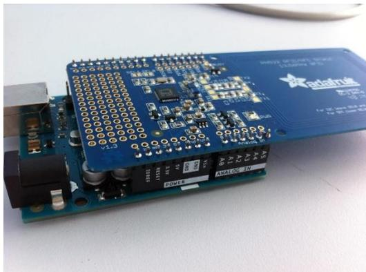
FIGURE 3. CARTE ARDUINO ET MODULE RFID
